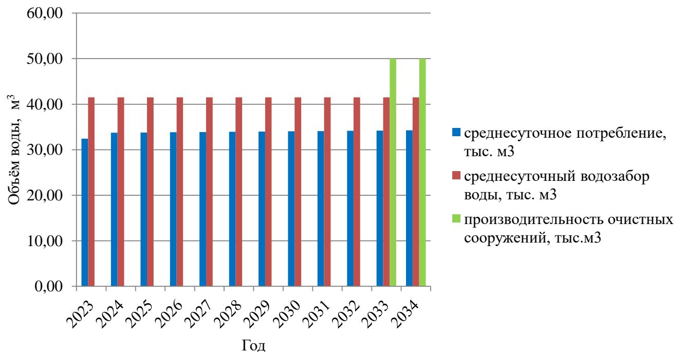
Рисунок 18 – Соотношение существующей и требуемой мощности водозаборных и очистных сооружений
