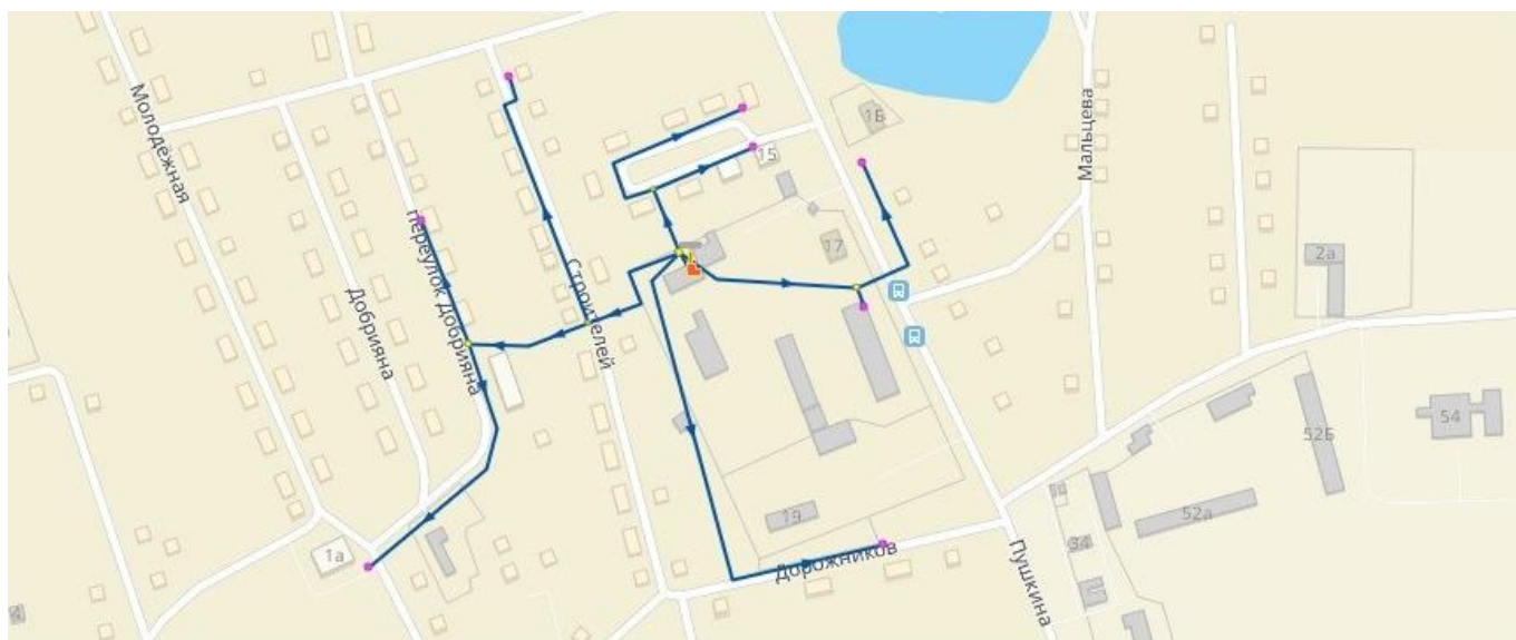
Рисунок 2.18 – Модель системы теплоснабжения котельной ДРСУ
