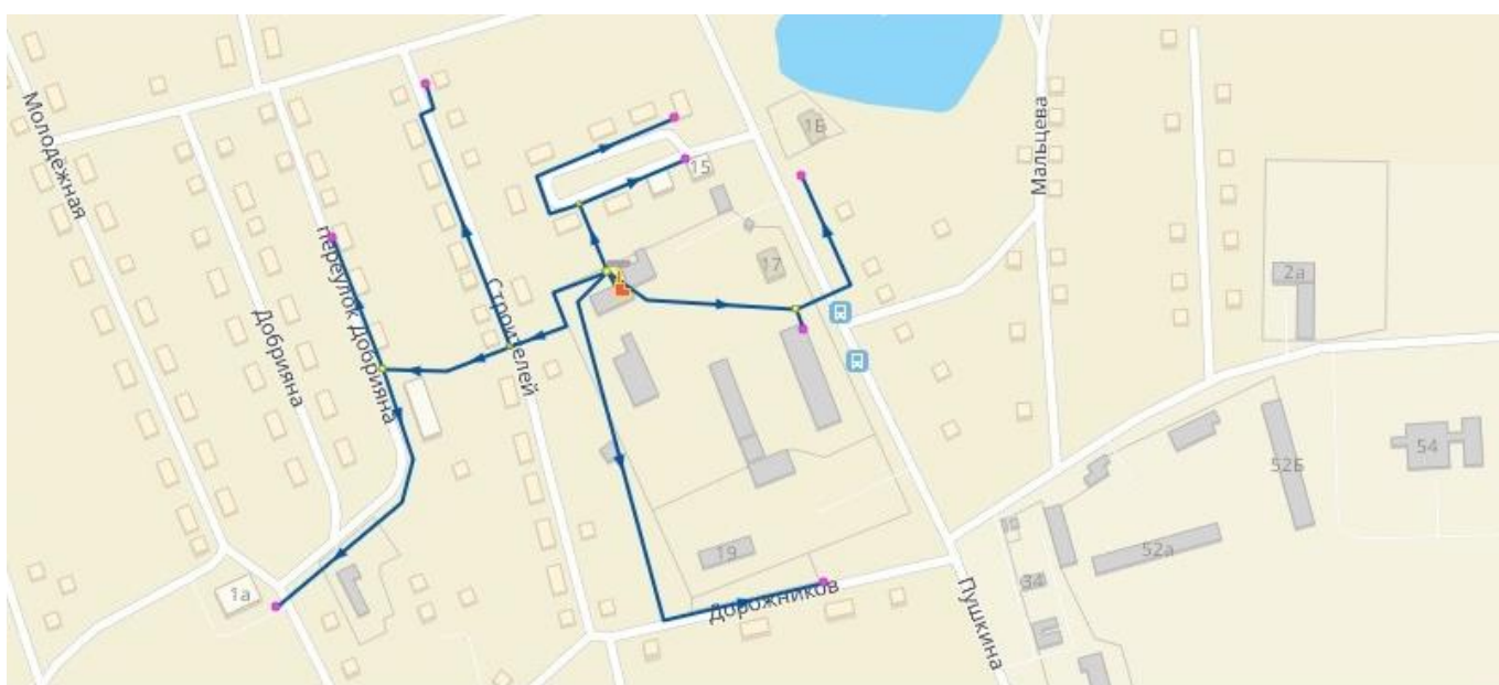
Рисунок 2.10 – Модель системы теплоснабжения котельной ДРСУ
