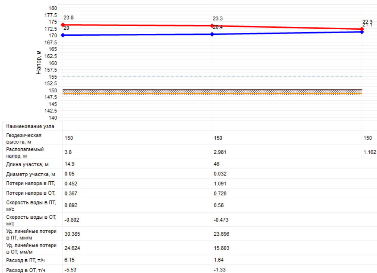
Рисунок 2.4 – Пьезометрический график тепловой сети котельной школы
