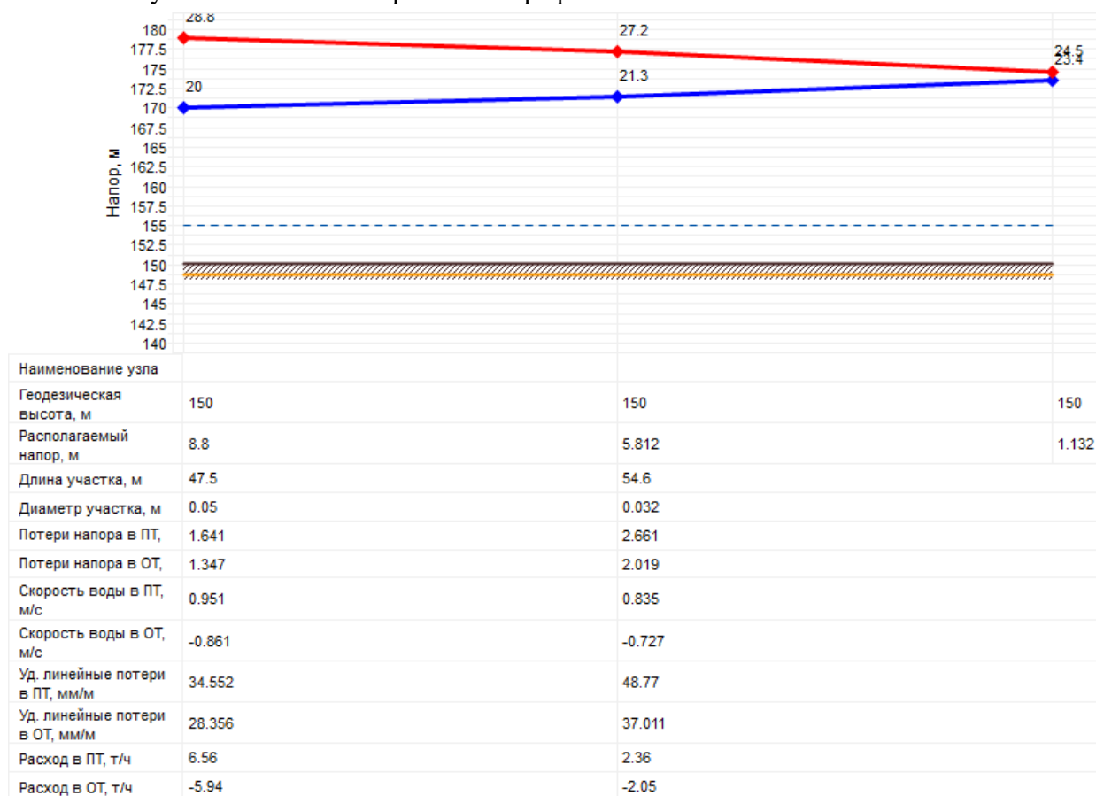
Рисунок 2.5 – Пьезометрический график тепловой сети котельной больницы
