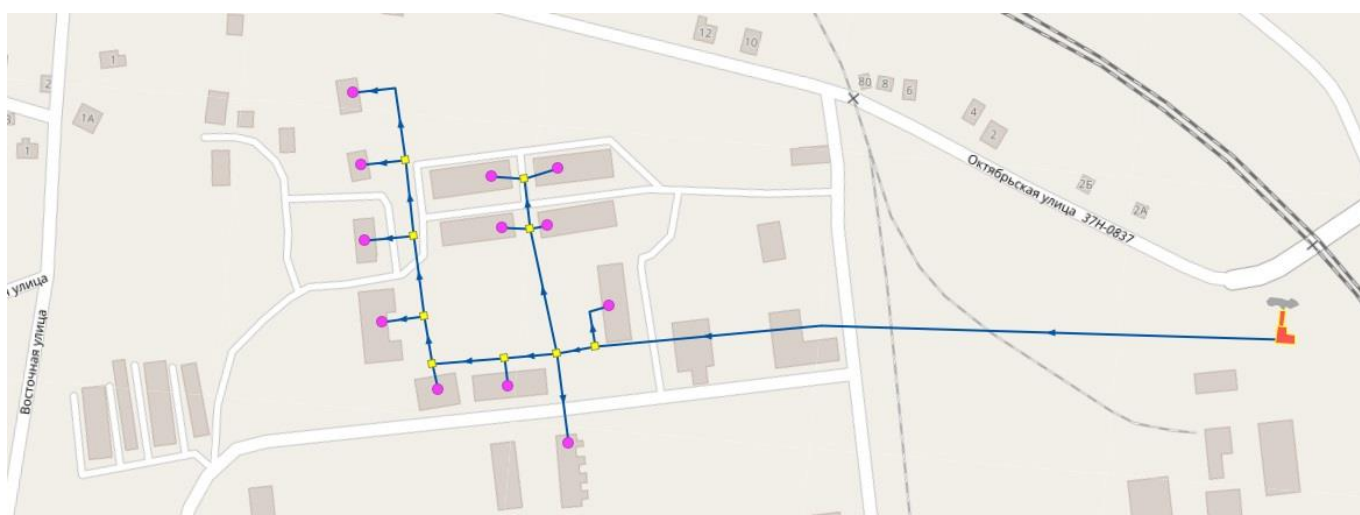
Рисунок 2.20 – Модель системы теплоснабжения котельной № 3 с. Иковка
