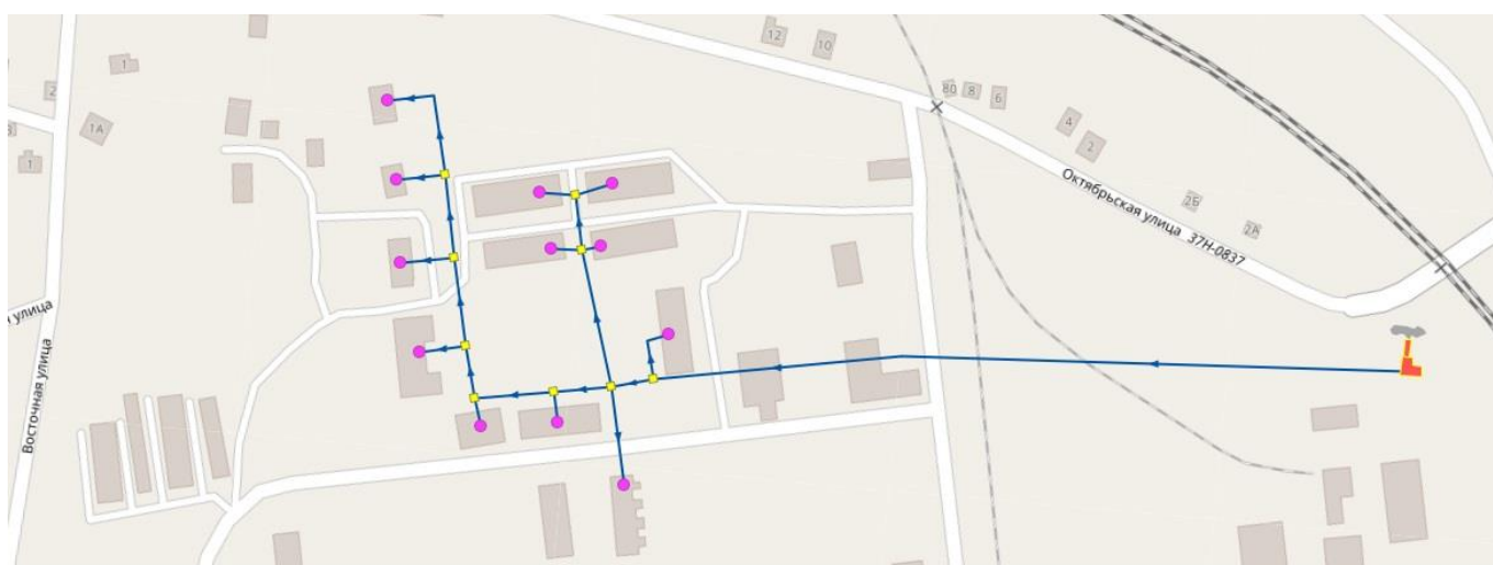
Рисунок 2.12 – Модель системы теплоснабжения котельной № 3 с. Иковка
