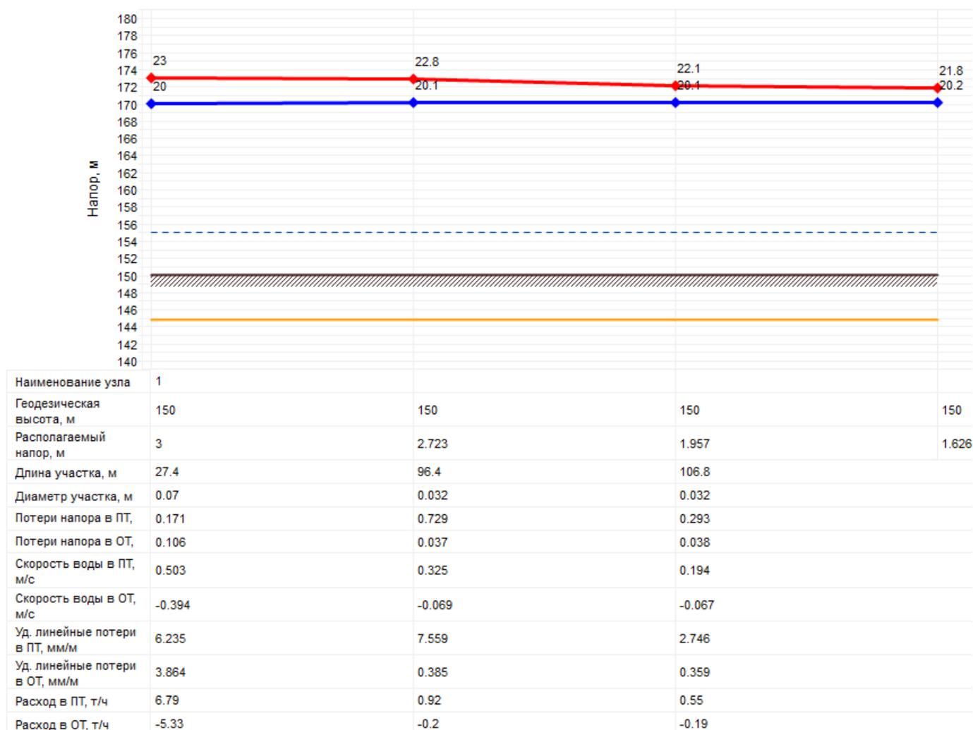
Рисунок 2.17 – Пьезометрический график от источника теплоснабжения (котельной ДК и детского сада с. Падеринское) до самого удаленного потребителя
