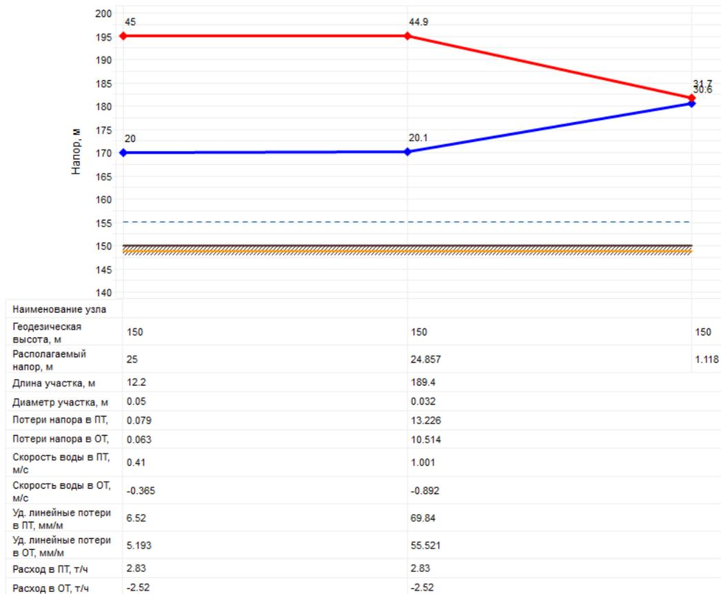
Рисунок 2.14 – Пьезометрический график от источника теплоснабжения (котельной ДК и детского сада с. Падеринское) до самого удаленного потребителя
