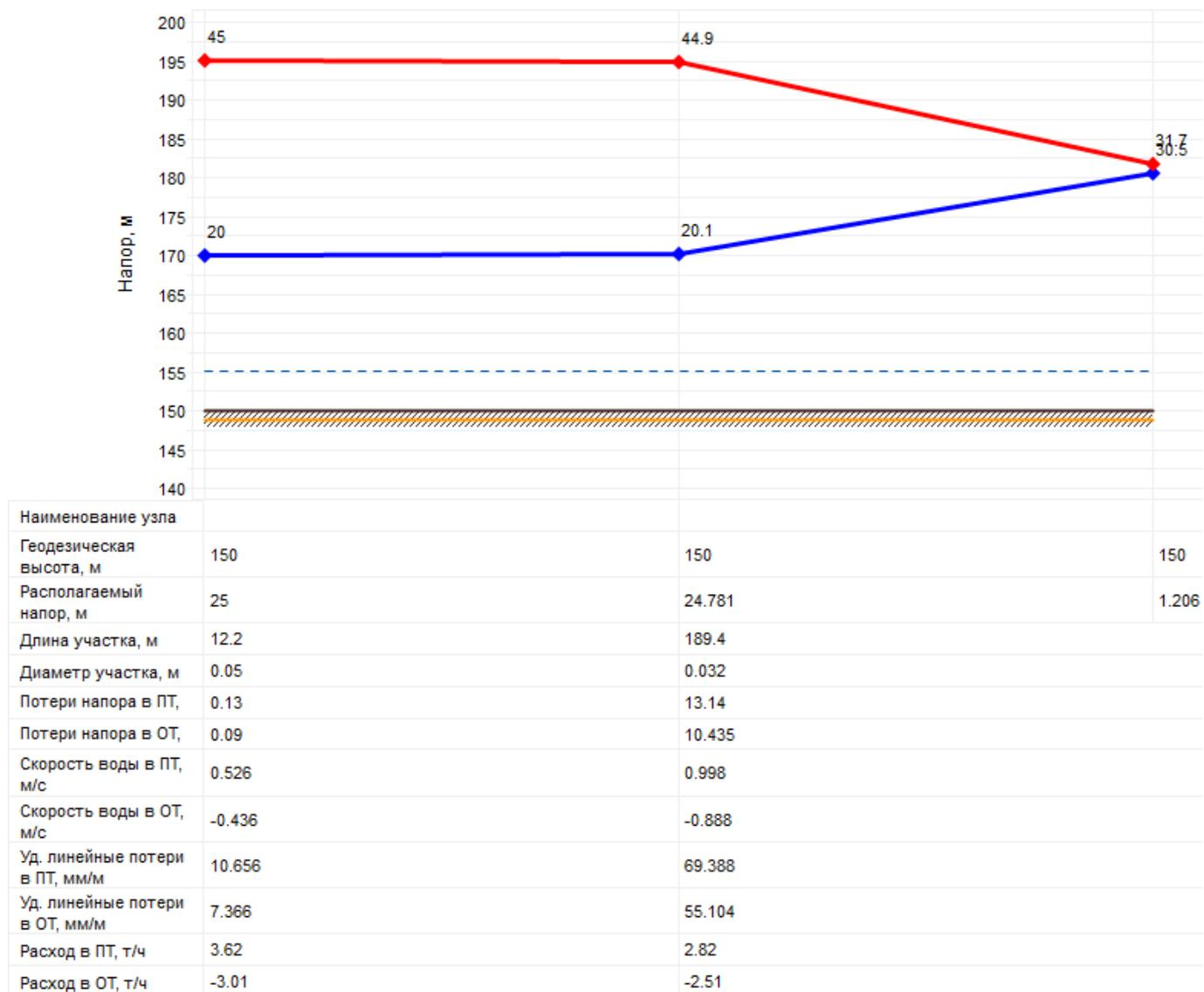
Рисунок 2.16 – Пьезометрический график от источника теплоснабжения (котельной ДК и детского сада с. Падеринское) до самого удаленного потребителя
