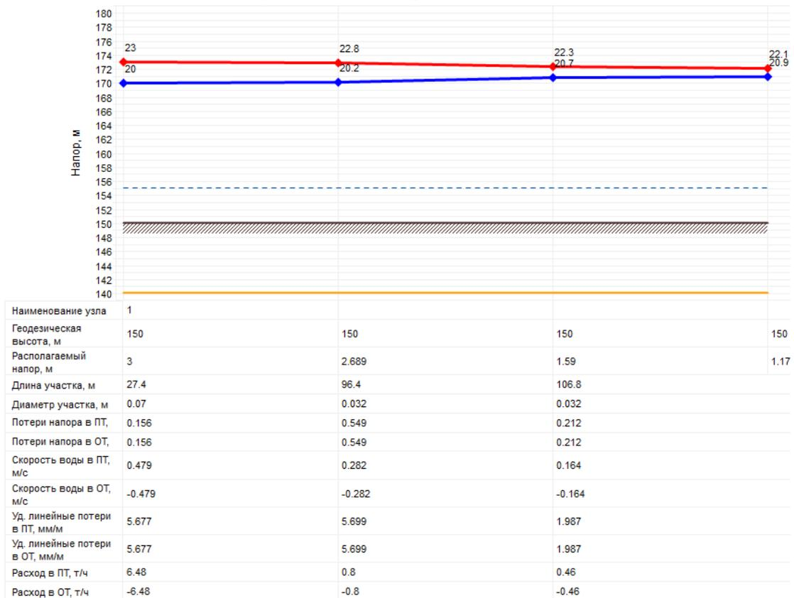
Рисунок 2.9 – Пьезометрический график тепловой сети по магистральному выводу котельной школы с. Падеринское до наиболее удаленного потребителя – здания ФАПа
