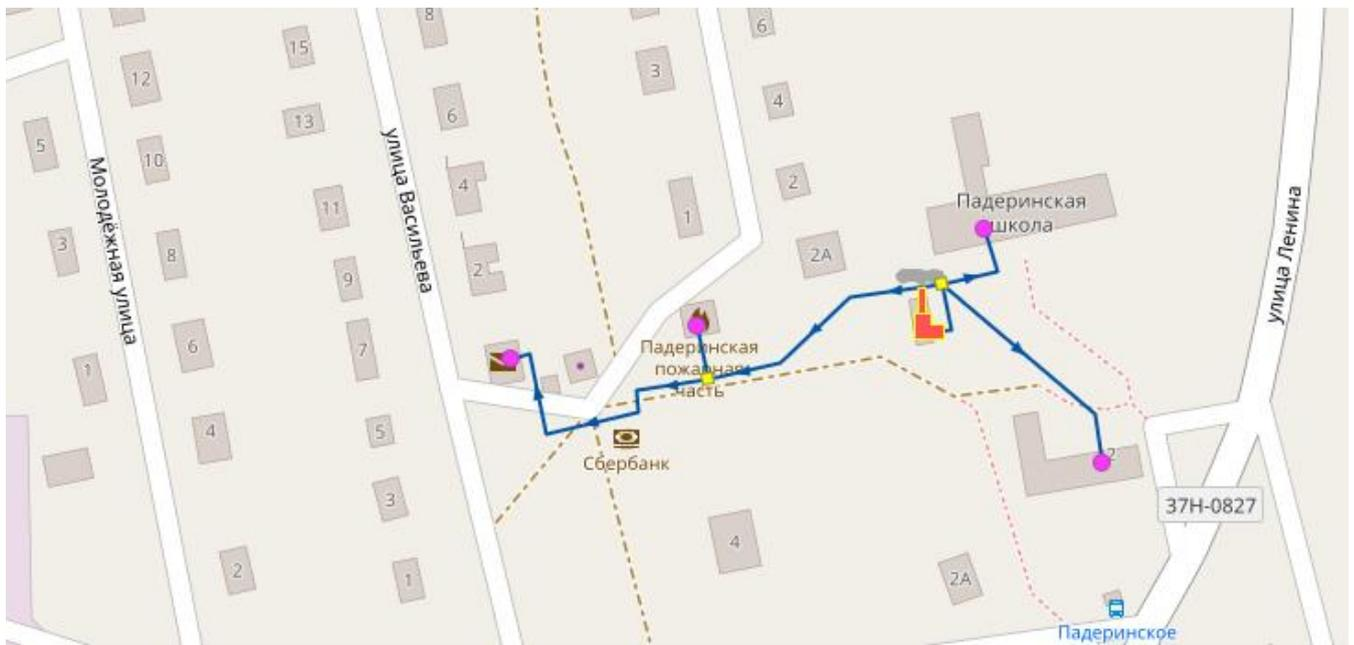
Рисунок 2.7 – Модель системы теплоснабжения котельной школы с. Падеринское
