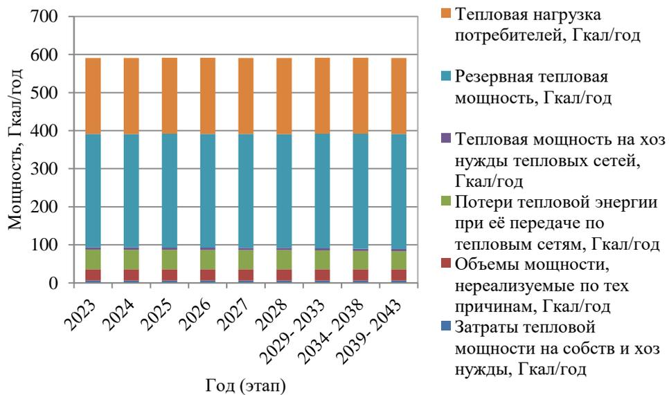
Рисунок 1.15 – Развернутый баланс тепловой энергии и тепловой нагрузки котельной школы с. Падеринское
