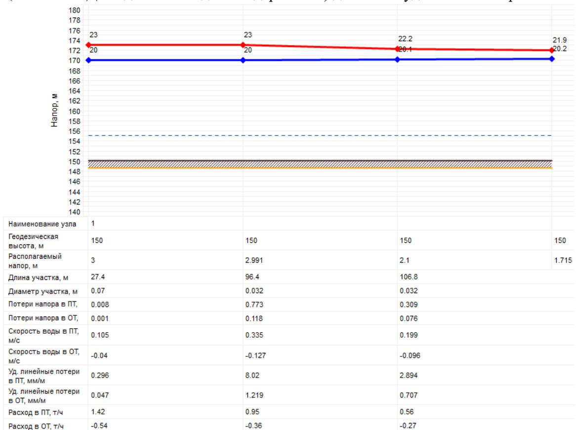
Рисунок 2.15 – Пьезометрический график от источника теплоснабжения (котельной школы с. Падеринское) до самого удаленного потребителя
