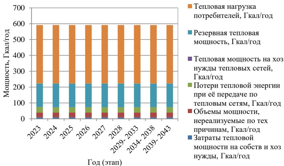
Рисунок 1.17 – Развернутый баланс тепловой энергии и тепловой нагрузки котельной ДК с детским садом с. Падеринское
