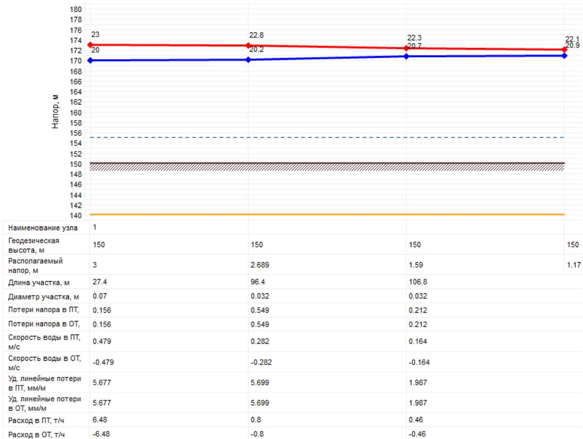
Рисунок 2.4 – Пьезометрический график тепловой сети центральной котельной школы с. Падеринское
