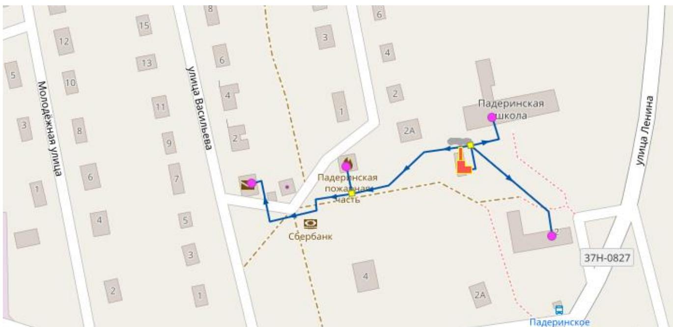
Рисунок 2.13 – Модель системы теплоснабжения котельной школы с. Падеринское
