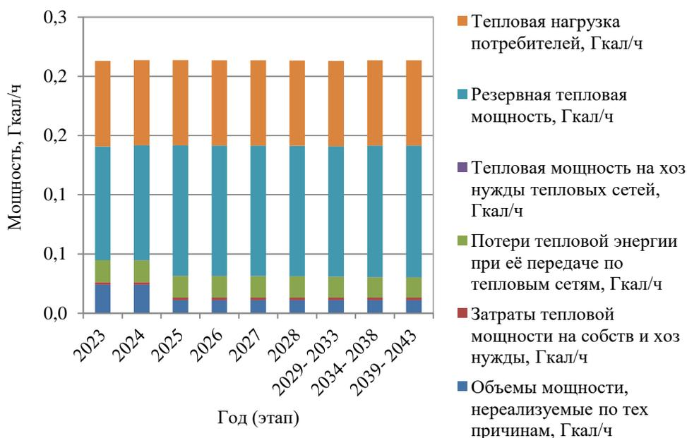
Рисунок 1.16 – Развернутый баланс тепловой мощности и тепловой нагрузки котельной школы с. Падеринское
