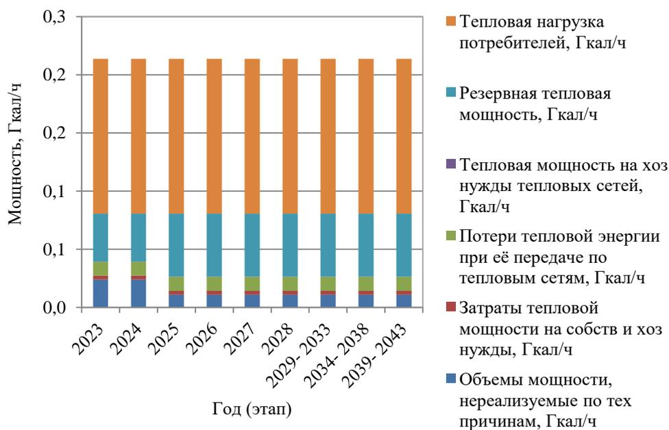
Рисунок 1.18 – Развернутый баланс тепловой мощности и тепловой нагрузки котельной ДК с детским садом с. Падеринское
