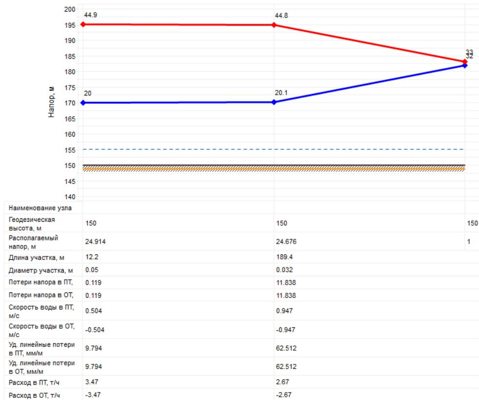
Рисунок 2.8 – Пьезометрический график тепловой сети по первому магистральному выводу центральной котельной ДК и детского сада с. Падеринское до наиболее удаленного потребителя – детского сада
