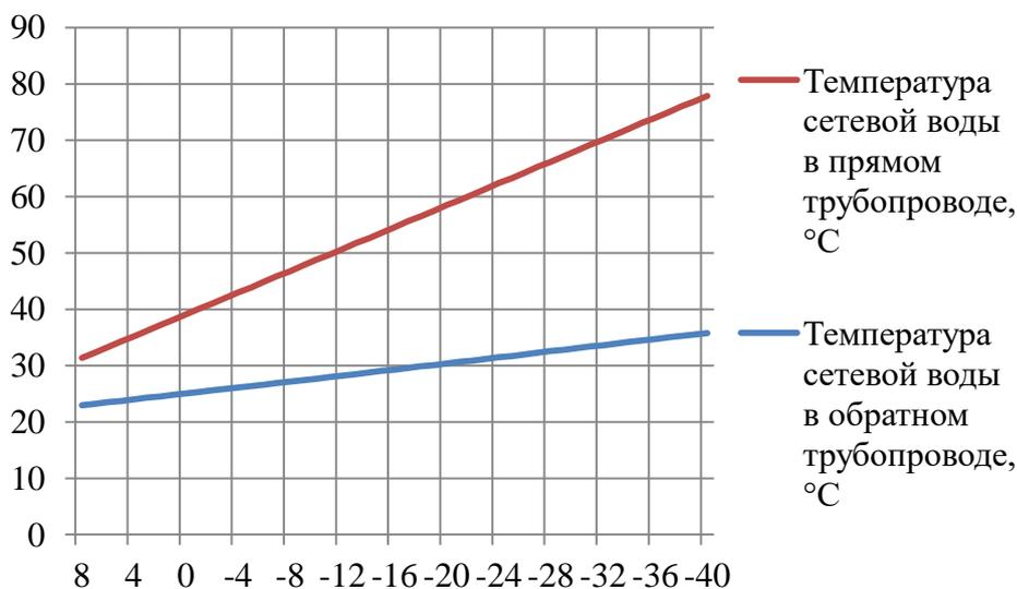
Рисунок 2.2 – График изменения температур теплоносителя центральных котельных с. Падеринское
