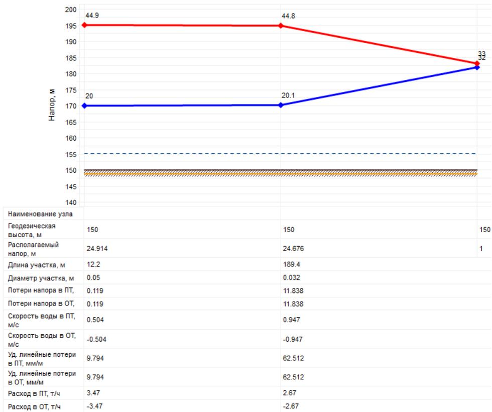
Рисунок 2.3 – Пьезометрический график тепловой сети центральной котельной ДК и детского сада с. Падеринское
