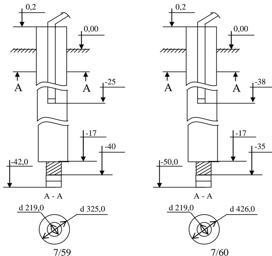
Рисунок 3 – Принципиальная схема установки водоподъемного оборудования в скважинах населенных пунктов
