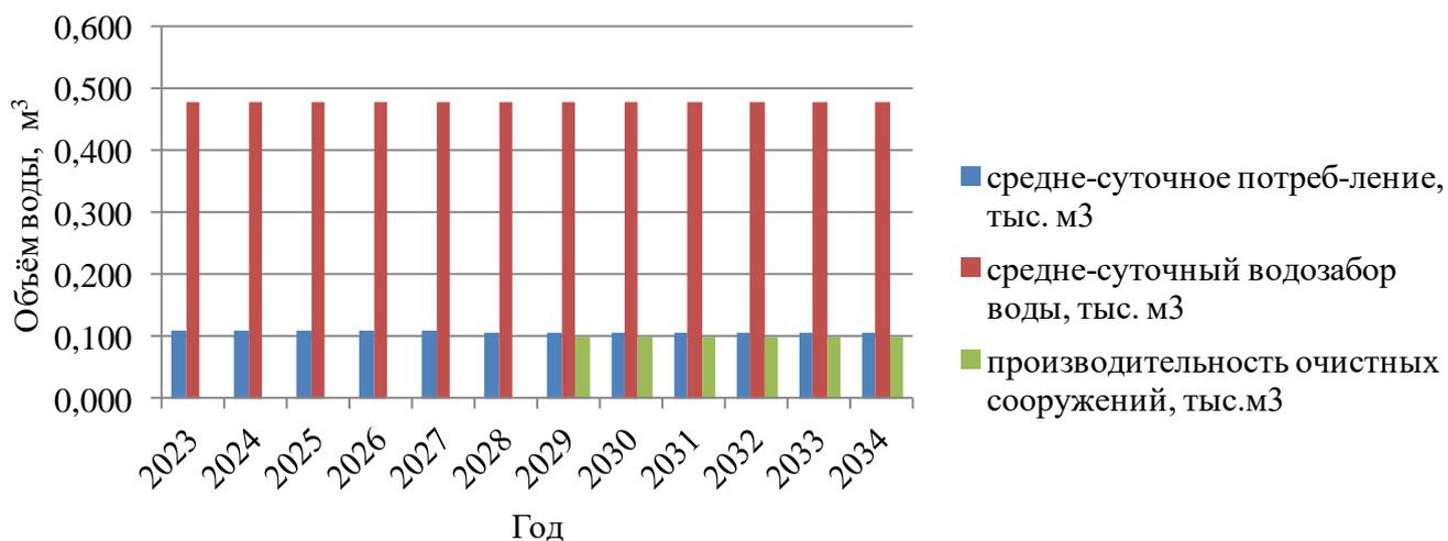
Рисунок 18 – Соотношение существующей и требуемой мощности водозаборных и очистных сооружений
