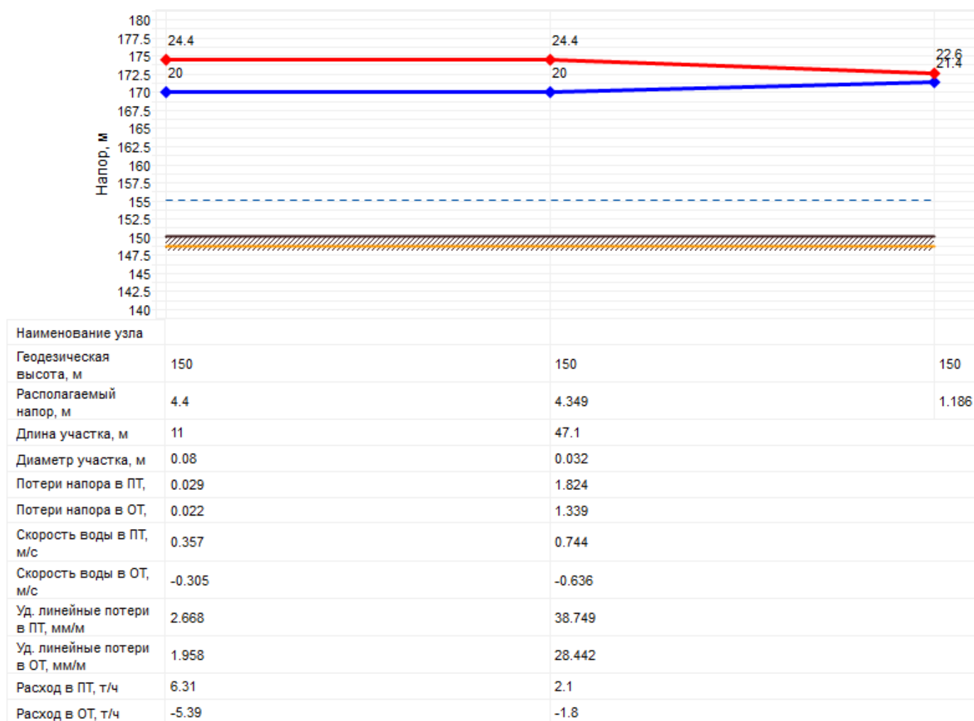
Рисунок 2.8 – Пьезометрический график от источника теплоснабжения (Котельной с. Колташево) до самого удаленного потребителя
