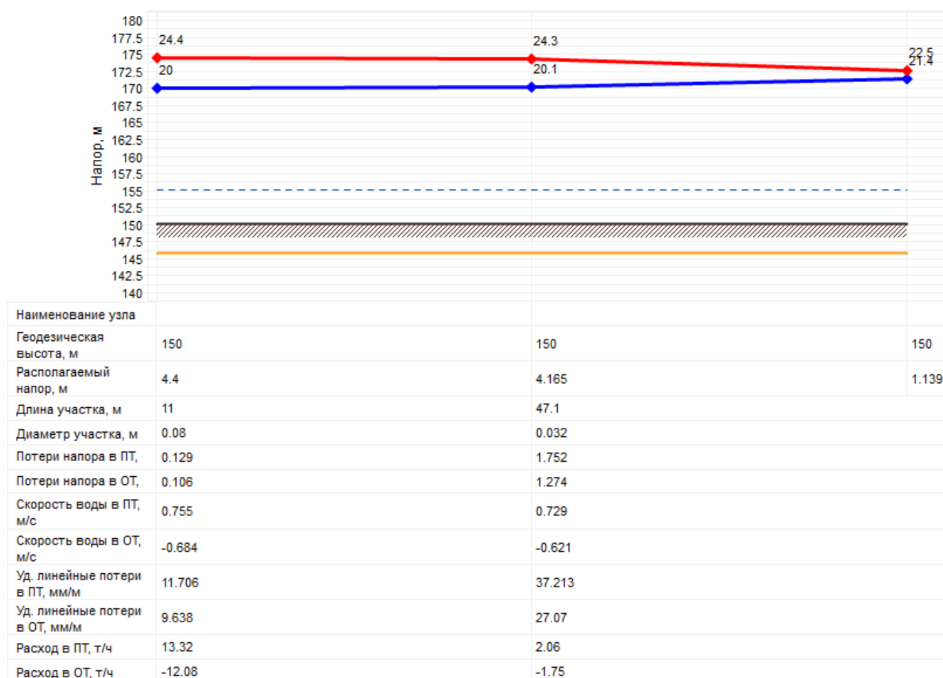
Рисунок 2.9 – Пьезометрический график от источника теплоснабжения (котельной с. Колташево) до самого удаленного потребителя в аварийной ситуации
