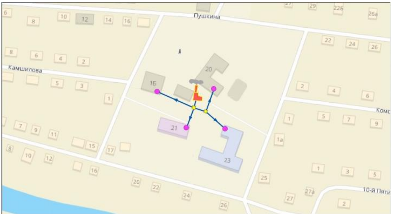
Рисунок 2.7 – Модель системы теплоснабжения котельной с. Колташево
