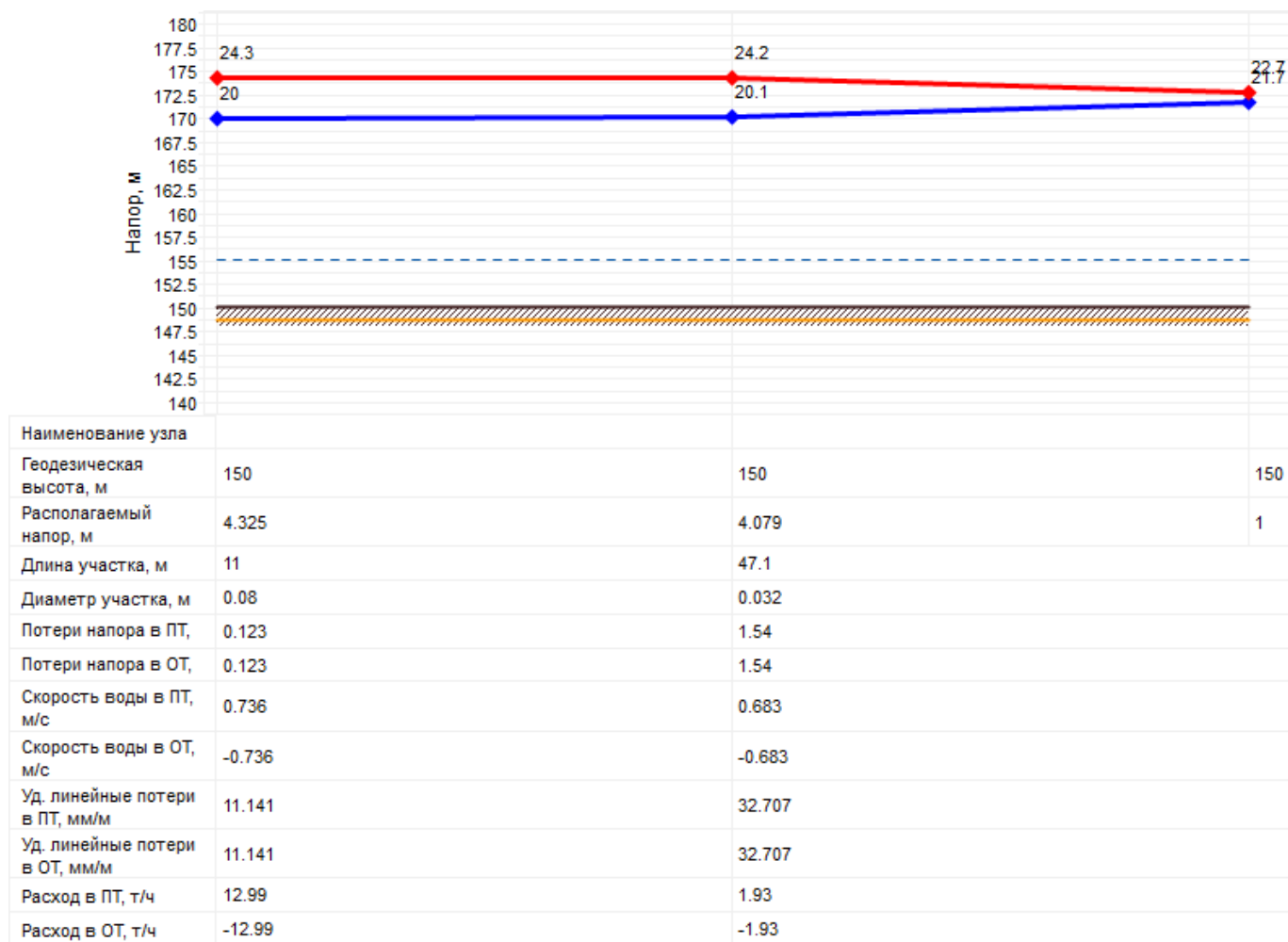
Рисунок 2.3 – Пьезометрический график тепловой сети центральной котельной до самого удаленного потребителя – ДК с. Колташево
