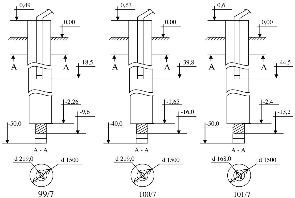
Рисунок 3 – Принципиальная схема установки водоподъемного оборудования в скважинах с. Колташево
