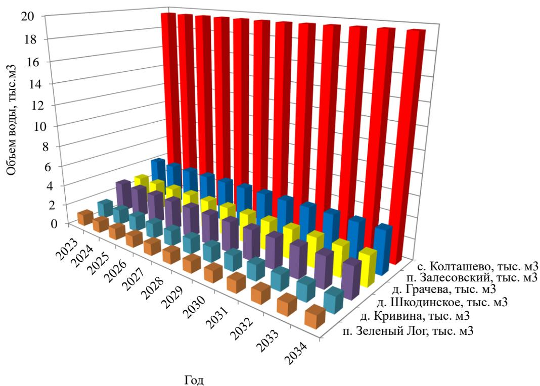
Рисунок 21 – Требуемая мощность очистных сооружений
