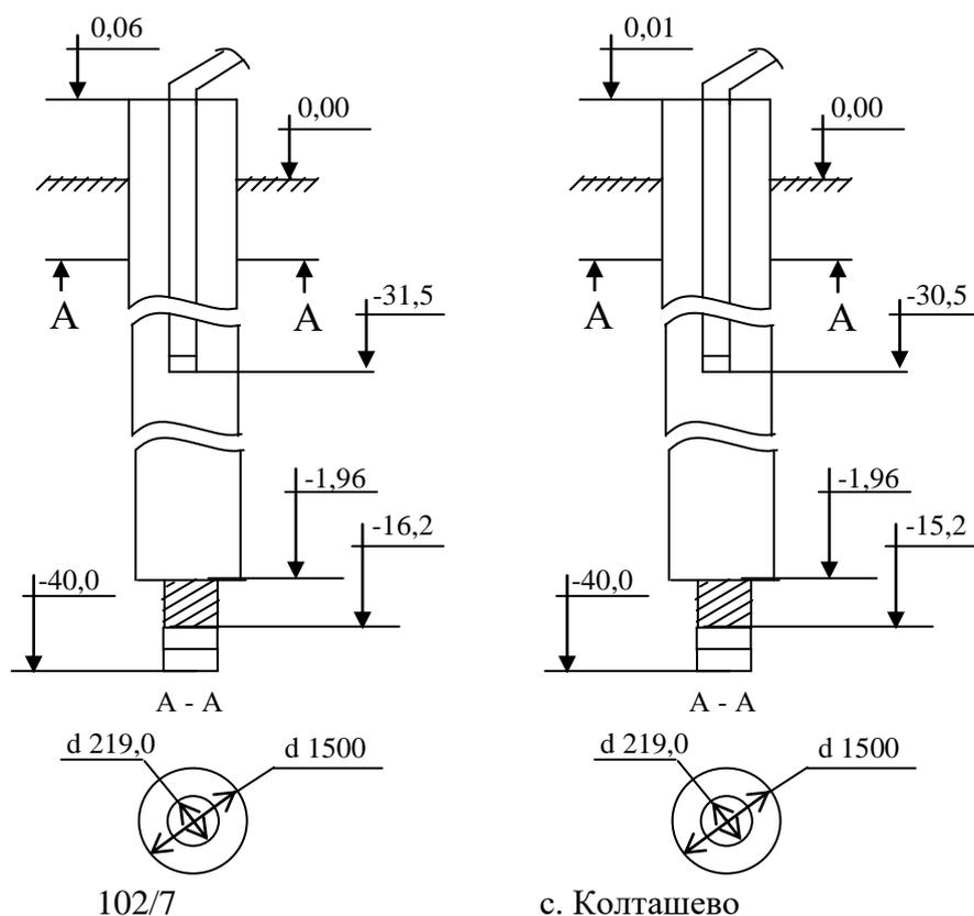
Рисунок 4 – Принципиальная схема установки водоподъемного оборудования в скважинах с. Колташево
