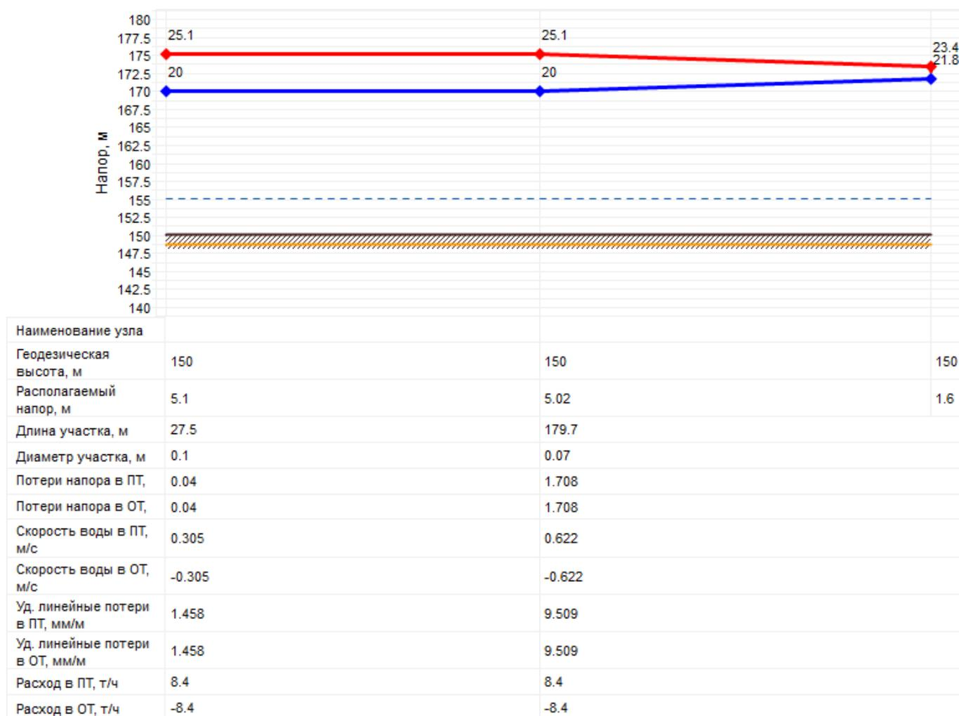
Рисунок 2.14 – Пьезометрический график от источника теплоснабжения (котельной школы с. Меншиково) до самого удаленного потребителя
