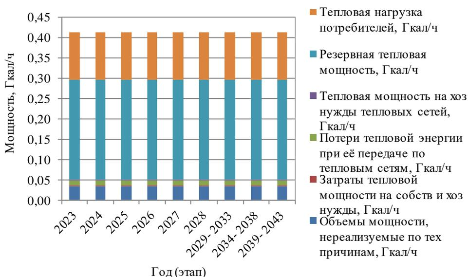
Рисунок 1.6 – Развернутый баланс тепловой мощности и тепловой нагрузки школьной котельной с. Меншиково
