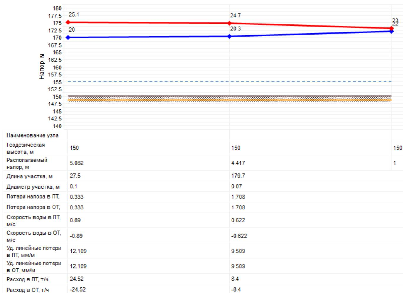
Рисунок 2.4 – Пьезометрический график тепловой сети котельной школы с. Менциково
