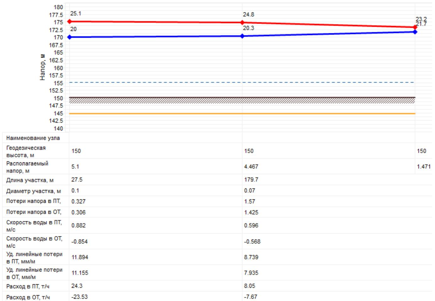
Рисунок 2.15 – Пьезометрический график от источника теплоснабжения (котельной школы с. Меншиково) до самого удаленного потребителя в аварийной ситуации
