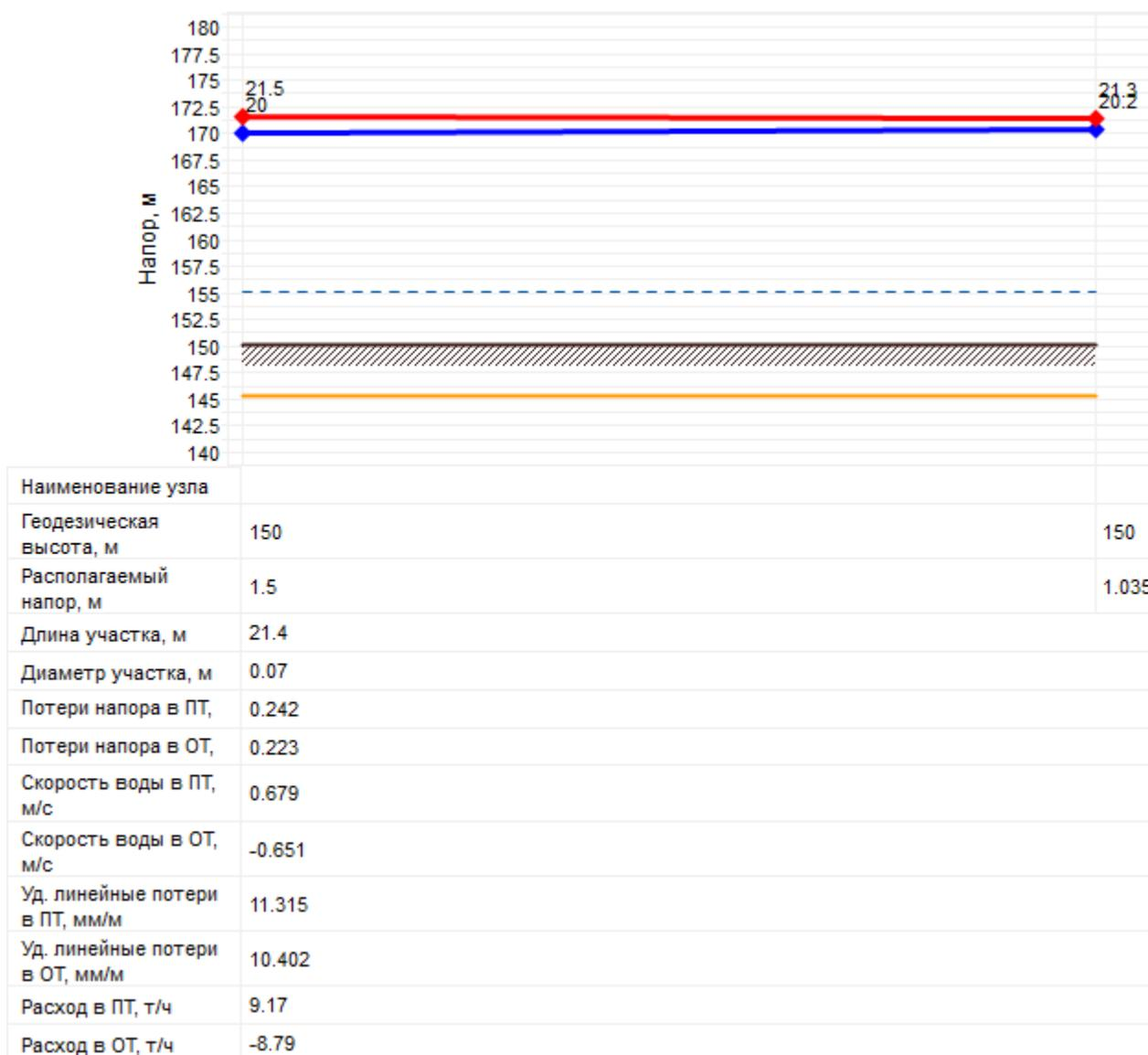
Рисунок 2.16 – Пьезометрический график от источника теплоснабжения (котельной детского сада с. Менщиково) до самого удаленного потребителя в аварийной ситуации
