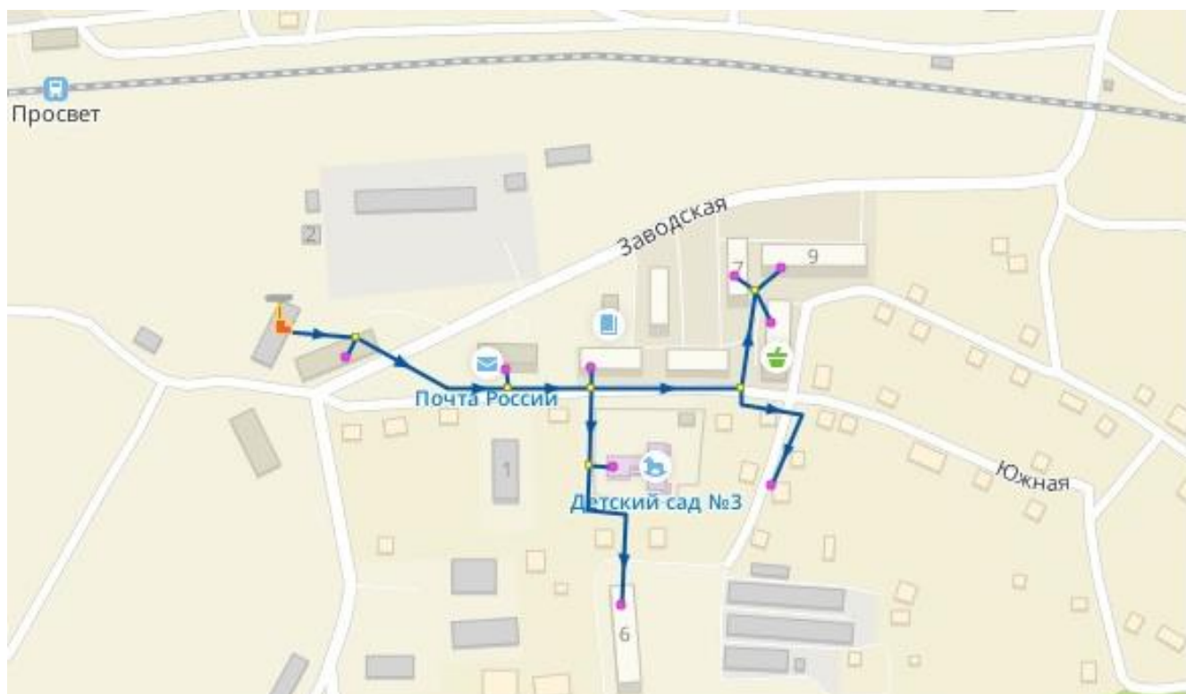
Рисунок 2.7 – Модель системы теплоснабжения котельной № 1
