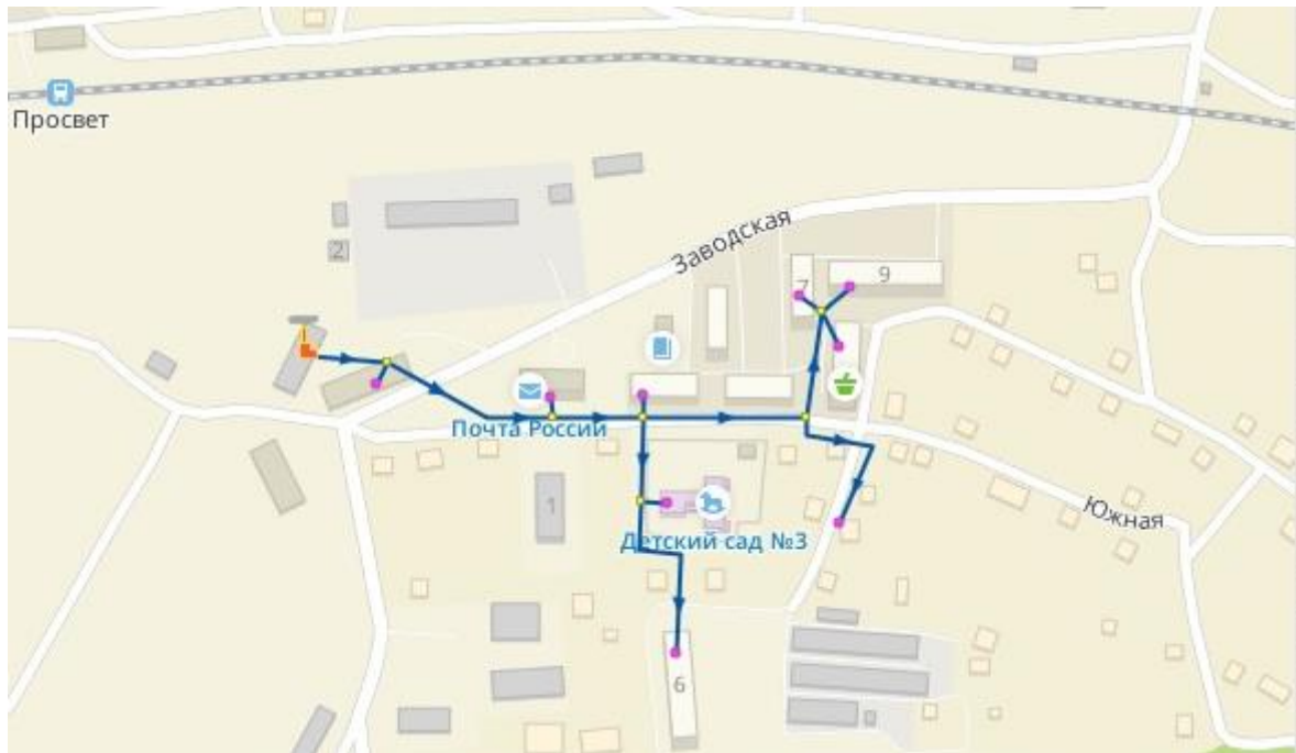
Рисунок 2.15 – Модель системы теплоснабжения котельной № 1
