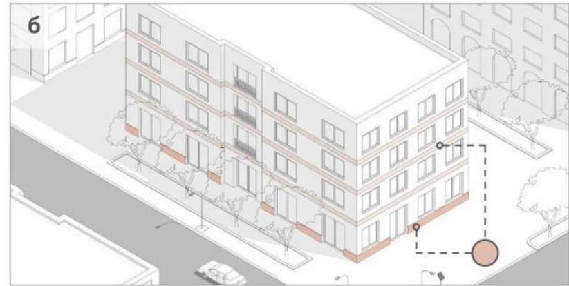
Цоколь в тон перекрытий
